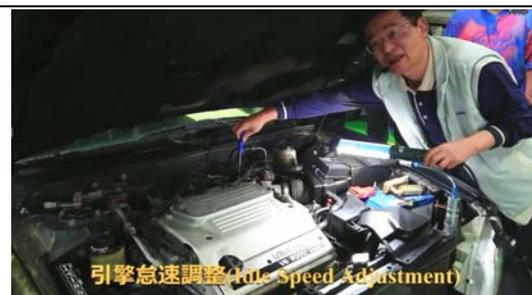
圖 4：Cefiro-引擎怠速調整(Idle Speed)
