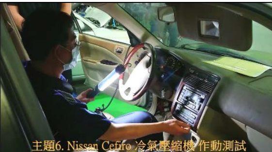
圖 6：Cefiro 冷氣壓縮機作動測試
