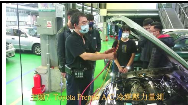
圖 7：Toyota Premio A/C 冷媒壓力量測
