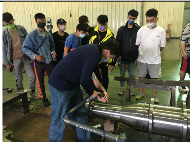
圖 2：學生親自操作雷射量測儀
